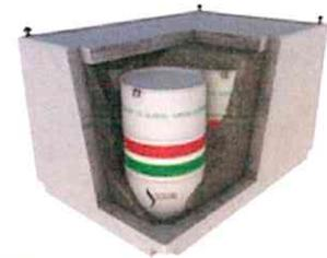
**COPERTURA** – Una volta riempite, le celle vengono sigillate e ricoperte con più strati di materiale opportuno, per prevenire infiltrazioni d'acqua
