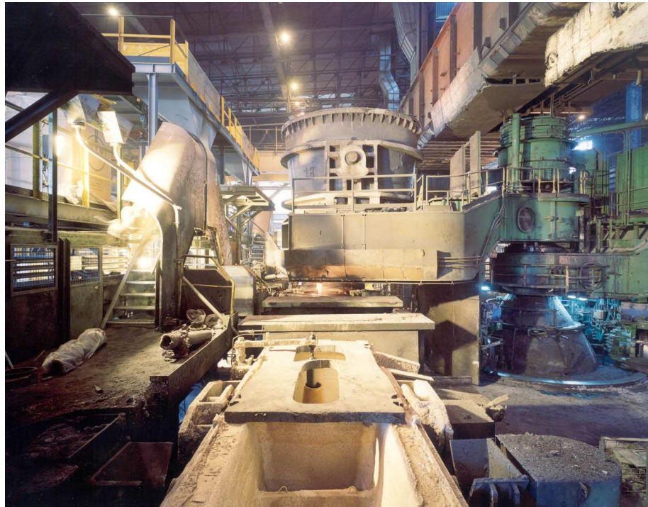
Colata continua: colaggio acciaio in paniera
