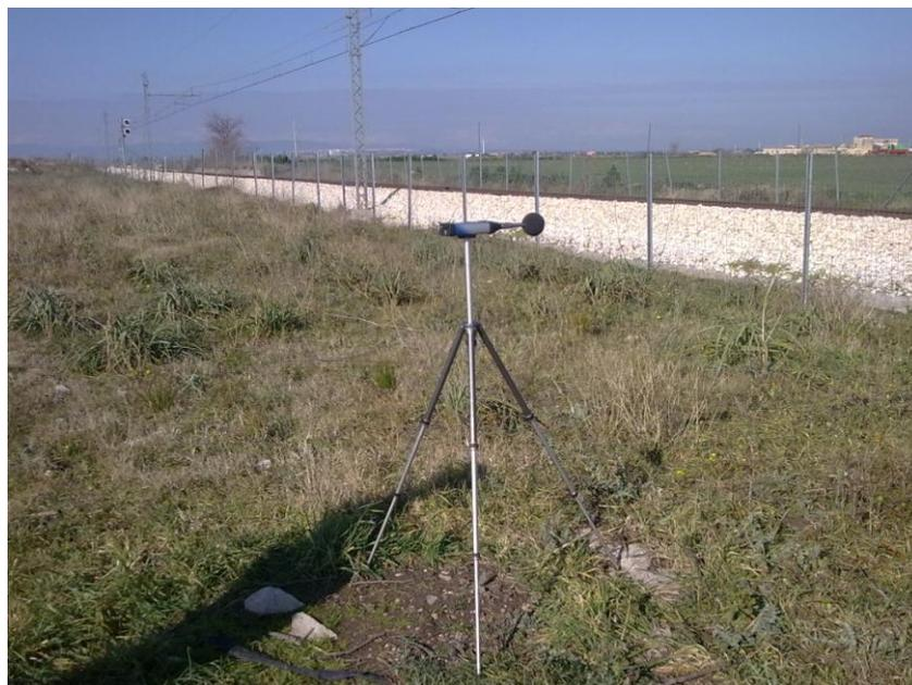
Figura 4.8 – Rilievo fonometrico presso la linea Foggia-Lucera
